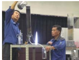
ろ過装置を通して、汚濁物質を取り除く
